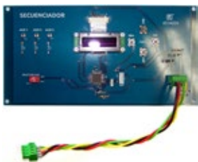
Secuenciador recolector (Sist. automático de recolecc. de almendra)
