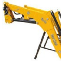
Bombines de elevación reforzados en pala nueva (Instalada en Torpedo)
