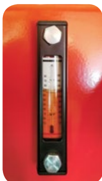
Nivel de aceite y control de temperatura
