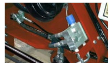
Kit regulador caudal descarga sinfin RT-100 *Solo para tractores con caudal superior a 60 L/min. Sin posibilidad de regulación.
