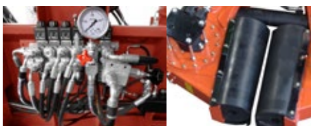
Regulación apriete pinza para VT-500 y VT-200
